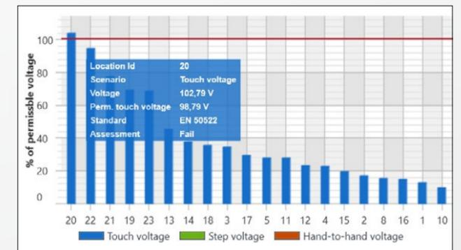
Medición de las tensiones de paso y de contacto con el medidor de mano HGT1
